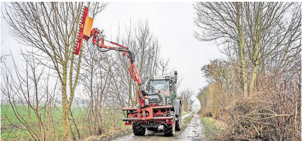
Carsten Bauer (links) und Peter Meyer schneiden in Bodennähe mit der Kettensäge Äste, Zweige und Stämme von Sträuchern und Bäumen an einem Feldweg bei Velber zurück. In vielen Bereichen setzen sie ein großes Heck- und Strauchschneidegerät ein, das an einem Traktor montiert ist. Dank eines meterlangen Auslegearms können sie damit selbst hohe und schwer zugängliche Gehölze bequem erreichen und das sogenannte Lichtraumprofil herstellen.
