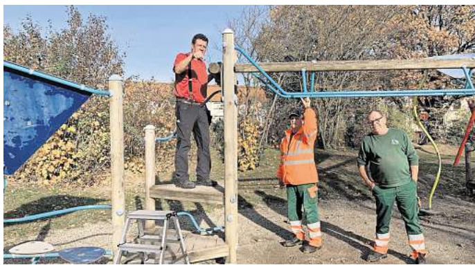
Als Teil der Jahreskontrolle begutachteten Spielplatzprüfer Bernhard Schmidt (links) sowie Stephan Brede und Michael Schulz die Stabilität ein Holzspielgerätes auf dem Spielplatz an der Döteberger Straße. Dabei überprüfen sie unter anderem die Rissbildung. Foto: Stadt Seelze
